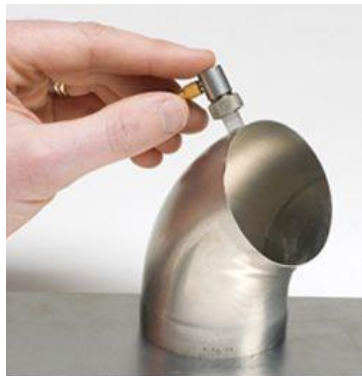
الشكل (34) قياس السماكة بمسبار أحادي مع خط تأخير
