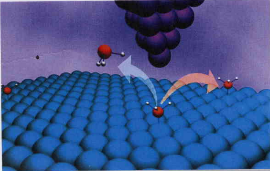
على سطح من النحاس (باللون الأزرق)، خضع نمطي الاهتزاز في جزيئة النشادر (باللون الأحمر) لتأثير مجهر ذي مغفول نفقي. وقد استخدم تيار شدته 408 MeV لاستئارة جزيئة النشادر بهدف تحديد الرابطة فيها، مما يؤدي إلى تقفها على السطح (السهم باللون الأزرق). ويتطابق شدة أخرى للتيار (139 MeV) تنعكس الجزيئة على السطح، كأنعكاس المظلة عند تعرضها للريح، ثم تنفضل عن السطح النحاسي (السهم باللون الأزرق).
