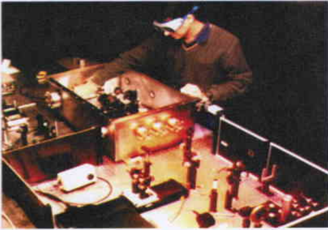
تستطيع هذه المنظومة الموجودة لدى جامعة كامبردج أن تصور الأشياء باستخدام نبضات من إشعاع تراهترتزي.
