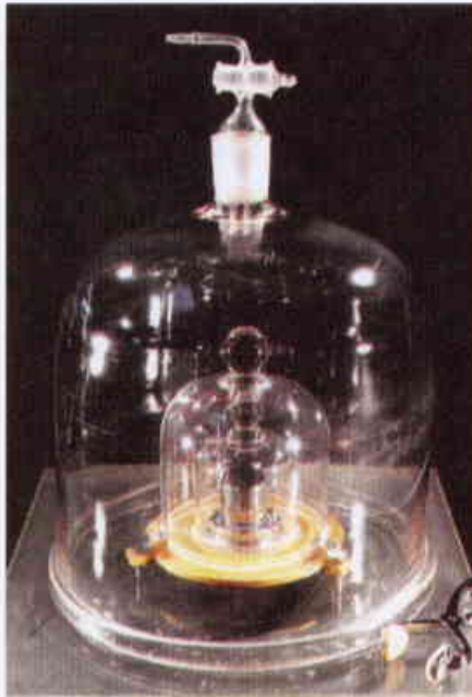
كتلة صناعية - الطريقة الوحيدة لمعرفة كتلة جسم ما فعلاً هي المتر إلى سيفر في فرنسا ومقارنة كتلة الجسم بالنموذج الأصلي الدولي للكيلوغرام (الذي تظهر نسخة منه هنا) والكيلوغرام هو الوحدة الأخيرة المتبقية من منظومة الوحدات الدولية SI. المستندة إلى جسم مادي، لكن علماء القياس يبحثون عن تعريف أكثر اتساقاً للكتلة.
