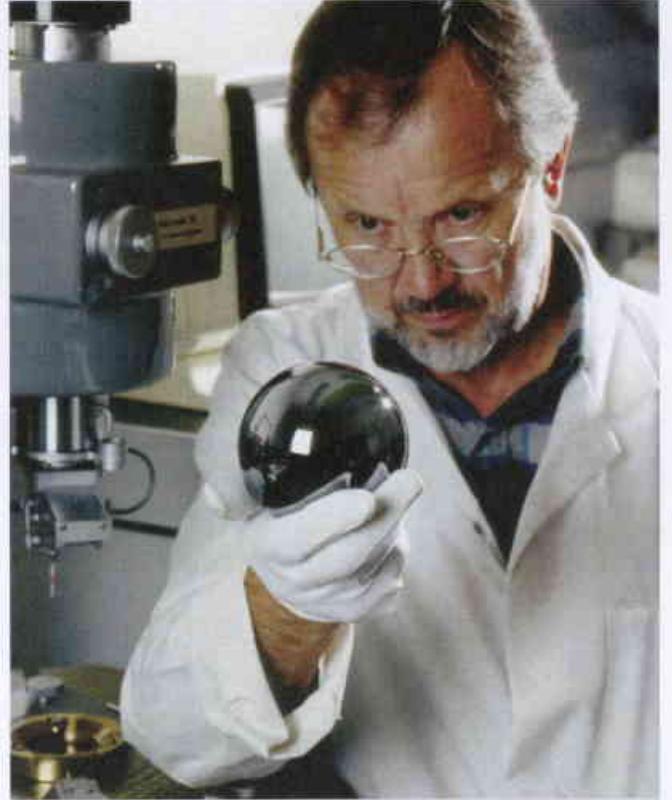
إحدى الطرق لتعريف الكيلوغرام هي حساب عدد الذرات في بلورة سيليسيوم لها الكتلة الاسمية 1 \text{ kg} . هي طريقة "أفوكادرو" هذه ينبغي أن يقاس حجم البلورة بدقة. ويكون هذا أسهل ما يمكن إذا كانت البلورة ذات شكل كروي. قطع هذه البلورة من بلورة نقية مكورة كبيرة وصلها أخيم لايبستر A. Leistner (في الأعلى) والعاملون معه هي منظمة الكومنولث للعلوم والبحوث الصناعية (CSIRO) في أستراليا حتى جعلوها لا تحيد عن كرة مثالية بأكثر من 50 \text{ nm} . ولو مددت البلورة حتى أصبحت بحجم الأرض لكان الضرب بين أعلى دروة واخفض وهدة فيها نحو 7 \text{ m} .
