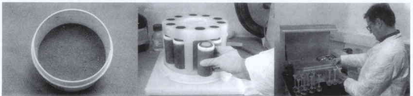
تحليل يُجرى في مخبر سايرسدورف لعينات تربة أُخذت من مناطق في كوسوفو حيث اكتشف اليورانيوم المستنفد في كوسوفو. إلى اليسار: عينة من التربة؛ إلى الوسط: معالجة العينات؛ إلى اليمين: تحليل العينات باستخدام مقياس الطيف الكلي للبلازما المقرونة بالتحريض.
