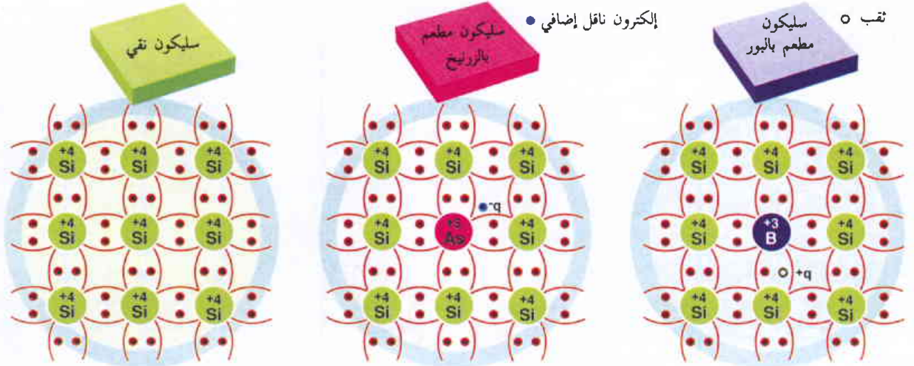
الشكل 2- السليكون النقي ناقل ضعيف. وبتطعيم المعدن بذرات مثل الزرنيخ او البور تزداد ناقلية بشكل مشير. q هي الشحنة الحرة، موجبة أو سالبة كما هو موضح.
