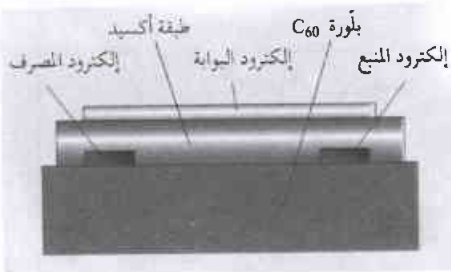
الشكل 2- تركيبة ترانزستور أثر الحقل التي استخدمها شون وآخرون [1] كي يحرضوا حاملات شحنة في بلورات C_{60} ، فتغير بذلك من عوازل إلى نواقل فائقة.
