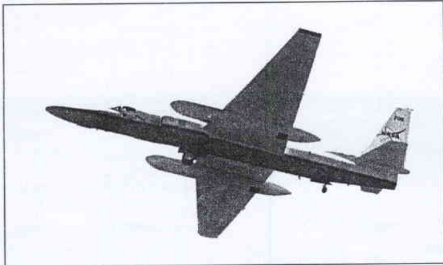
طائرة ER-2 تابعة لوكالة ناسا في مرحلة الإقلاع. وتبدو محتات الإشعاع من أجل قياسات الأشعة المؤينة الجوية محمولة في مقدمة الطائرة، وفي جسم الطائرة خلف قمرة الطيار، وفي الثلث الأمامي من خزانات الوقود تحت الجناح.
