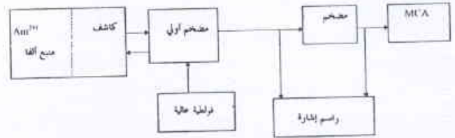
الشكل 2- المخطط الصندوقي لمنظومة قياس طيف طاقة الإشعاع.
