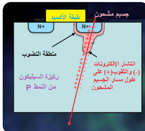
الشكل 5. رسم تخطيطي يوضح مفهوم تأثيرات الحادثة الأحادية SEE-Single Event Effects الذي يسببه جسيم مشحون ذو طاقة عالية داخل عنصر إلكتروني (MOSFET).
