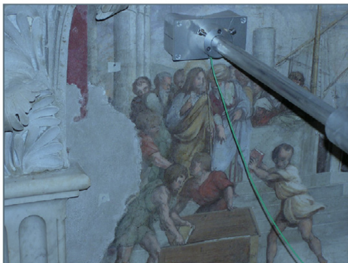
الشكل 6. قياس الرطوبة في لوحة فنية من القرن الخامس عشر باستخدام الطنين النووي المغناطيسي أحادي الجانب.
