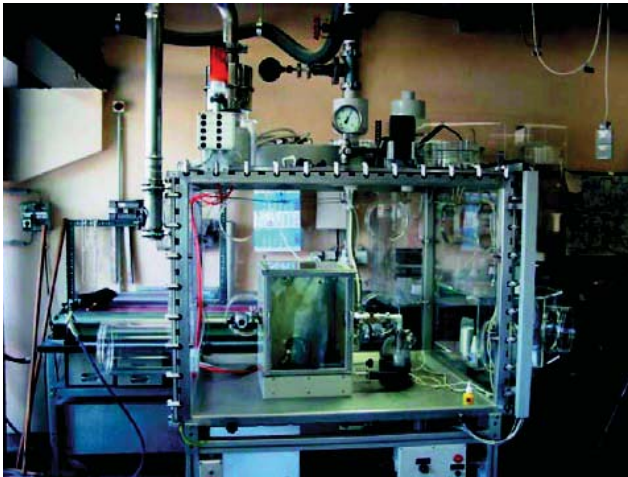
الشكل 7. صندوق قفازي لمعالجة خاصة للمادة النووية.
