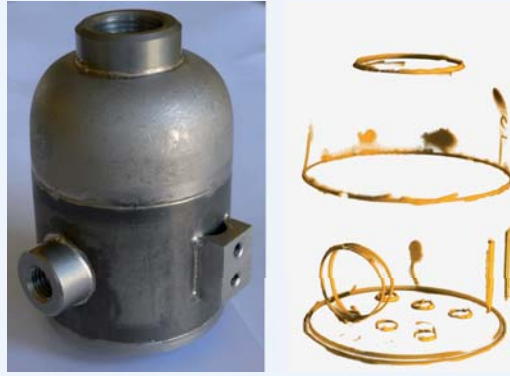
صورة ثلاثية الأبعاد لوصلات اللحام في مبادل حراري، المصدر: PSI، سويسرا
