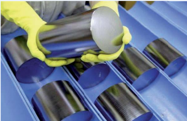
السليكون المعدل للتطعيم بالتحويل النيوتروني، المصدر: NTP Radioisotopes(Pty)Ltd، أفريقيا الجنوبية
