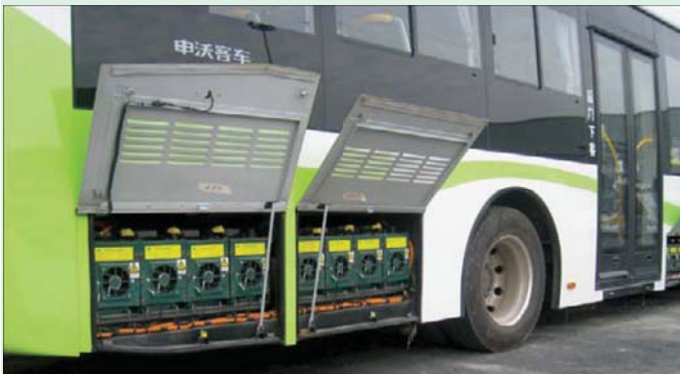
تستعمل شركة إنتاج باصات صينية مكثفات فائقة في بعض مركباتها الكهربائية.
