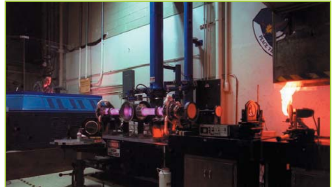
الشكل 10. ليزر ثاني أكسيد الكربون مستمر باستطاعة 50 كيلو واط لمعالجة المعادن
