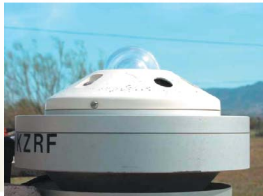
بيرانومتر مع حساس حراري لقياسات كثافة التدفق الإشعاعي العمومي global irradiance measurements
