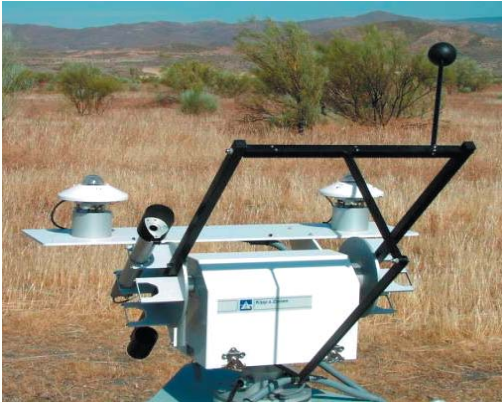
بيرانومتر مع كرة تظليل shading ball من أجل قياسات كثافة التدفق الإشعاعي المنتثر diffused irradiance measurements
