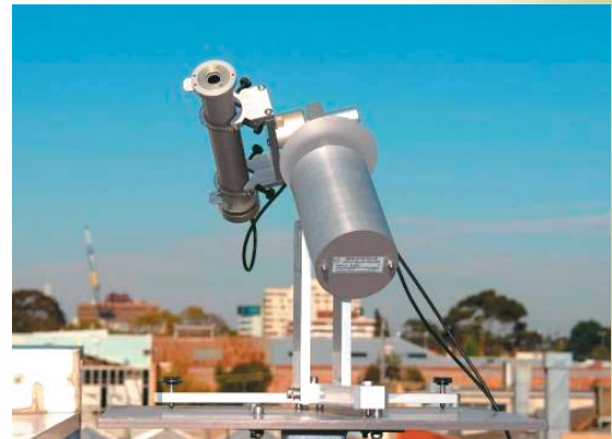
بيرهيليومتر pyrheliometer ملاحق ثنائي المحاور خاص بقياسات كثافة التدفق الإشعاعي العادي المباشر direct normal irradiance measurements
