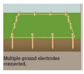
يجب العمل على أن تكون مقاومة الدارة الأرضية أقل ما يمكن كما ويجب إجراء اختبارات لاحقة للتأكد من صلاحية مقاومة الوصلات الأرضية وصلاحية الأرض الموصلة بها بواسطة أجهزة القياس الخاصة وصيانة الموصلات الأرضية بشكل دائم.
