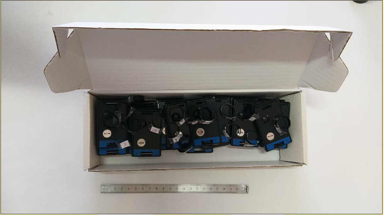
الشكل 1: مقاييس جرعة كامل الجسم ومقاييس جرعة الأطراف (الخواتم باللون الأسود)
