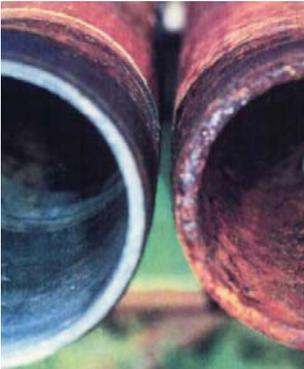
الرواسب الحرشفية المشعة ضمن أنابيب استخراج النفط (الأنبوب قبل وبعد التنظيف بواسطة الماء المضغوط)
