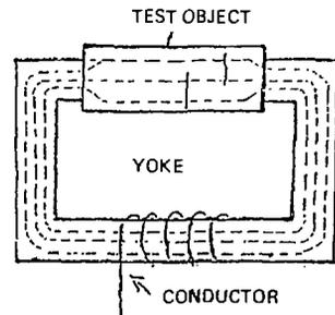
Figure 1.6 : Electromagnet
