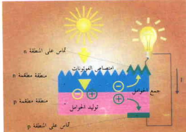
وعندما يضاء هذا الديود تختص المادة الفوتونات، وكل فوتون يولد إلكتروناً وثقباً (يقال زوج الكترون - ثقب). وتفصل وصلة الديود الإلكترونات عن الثقوب محدثة اختلافاً في الكثافة بين التماسين  $n$  و  $p$ ، ويسري تيار إذا وضعت مقاومة بين التماسين والديود (انظر الشكل).
