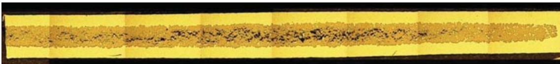
الشكل 3. فشل صفيحة الوقود المبدّد U(Mo) في تجربة المستقبل
