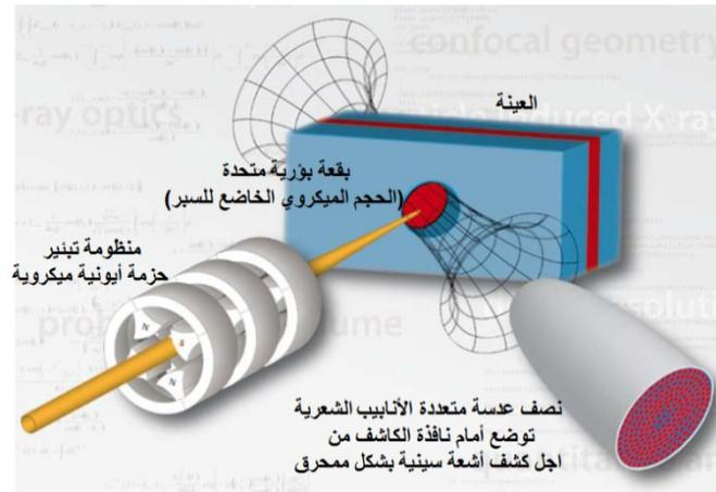
الشكل 10. الترتيب الهندسي لتقنية  $\mu$ -XRF متحدة البؤر.
