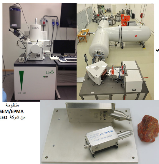
منظومة XRF مصغرة من شركة Amptek
