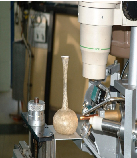
الشكل 13. دراسة عينة أثرية باستعمال حزمة أيونية في الهواء.
