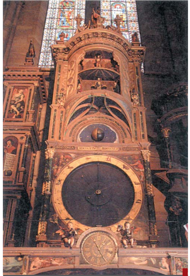
المِيقَاتِيَّة الفلكية في كاتدرائية ستراسبورغ هي حاسب تماثلي يتيح التنبؤ بمواضع الكواكب والنجوم.
